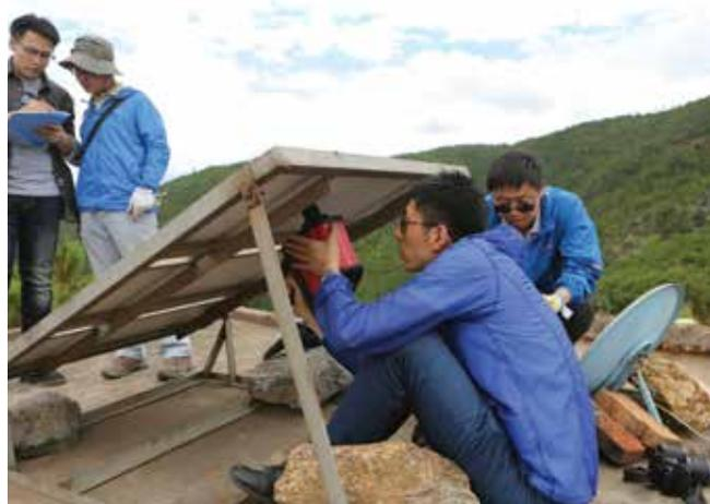
工作人员通过傅立叶红外光谱设备检测发现，这些组件均使用基于杜邦™ 特能® PVF薄膜的背板。
