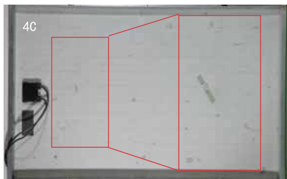
图4C 安装4年后在聚酯背板出现裂纹（西班牙）
