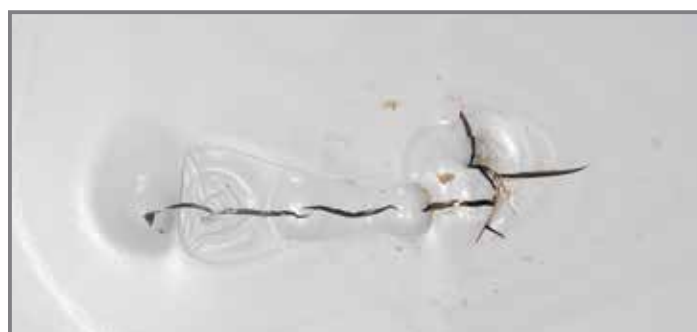
图 5. 聚偏氟乙烯背板上的高强度热斑
